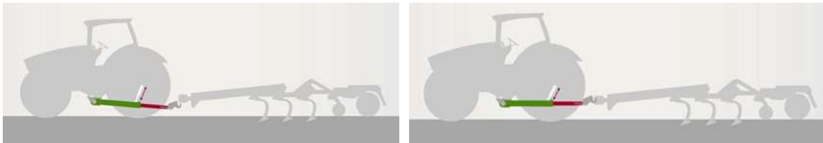
3.42 ábra Vonórúd magasságának változtatása
